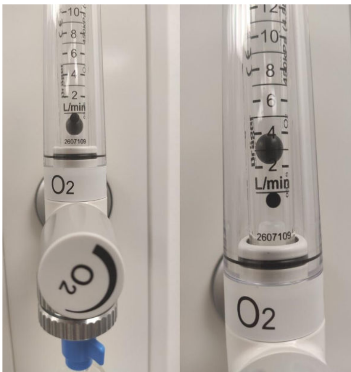
Abbildung 4: Korrekte Ablesung des Schwebekörpers (hier „Nordpol“) am Röhrendurchflussmesser (rechts im Bild sind 4 L O 2 /min eingestellt)
