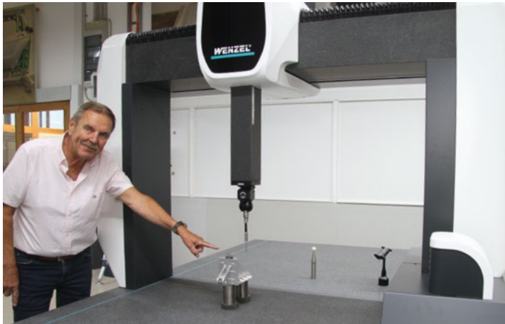
Peter Eickworth steht an der neuen 3D-Messmaschine, sie arbeitet in höchster Genauigkeit (1,5 Mikrometer) für die Werkstücke.
